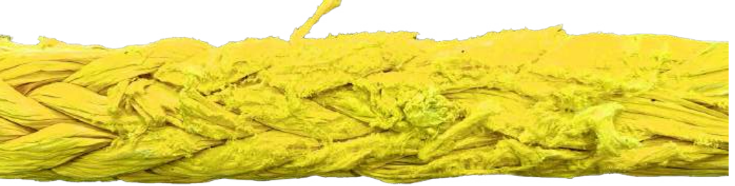
Şekil 7. Bölgesel sürtünme kaynaklı ısı oluşumuyla filamentlerde erime
