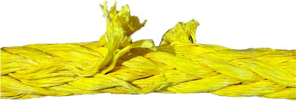
Şekil 4. Bölgesel yıpranmadan kaynaklı halatta kol kesilmesi
