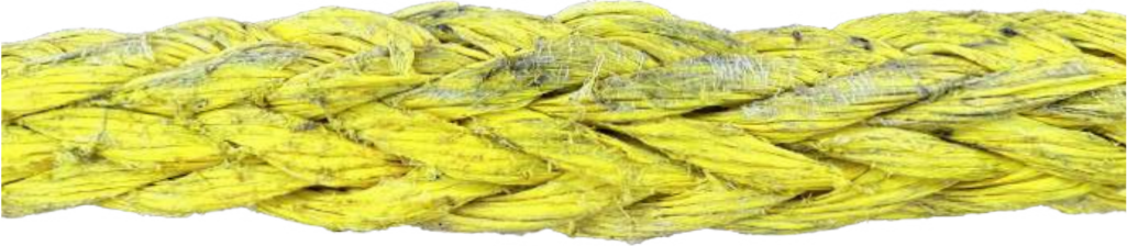
Şekil 6. Şok yüke maruz kalan halatta iç damarların kopması sonucu oluşan düzensiz çap
