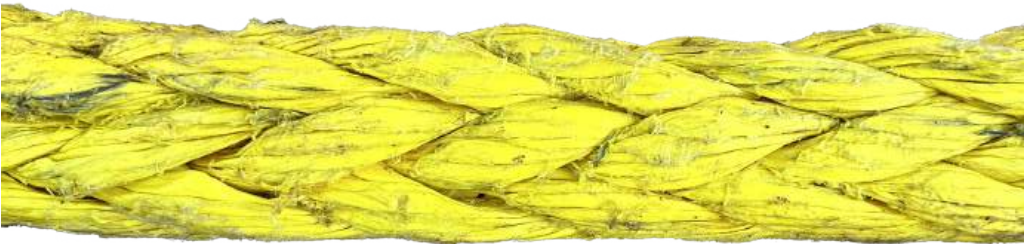
Şekil 3. Çalışırken yıpranmış 12 kollu DYNE K halat
